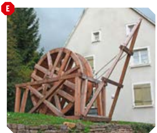
CAGE À ÉCUREUIL, SYSTÈME DE LEVAGE. Reconstitution à Ferrette (France).
