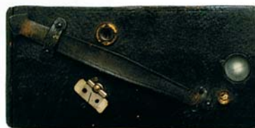
Levier d'armement pour faire avancer le film
